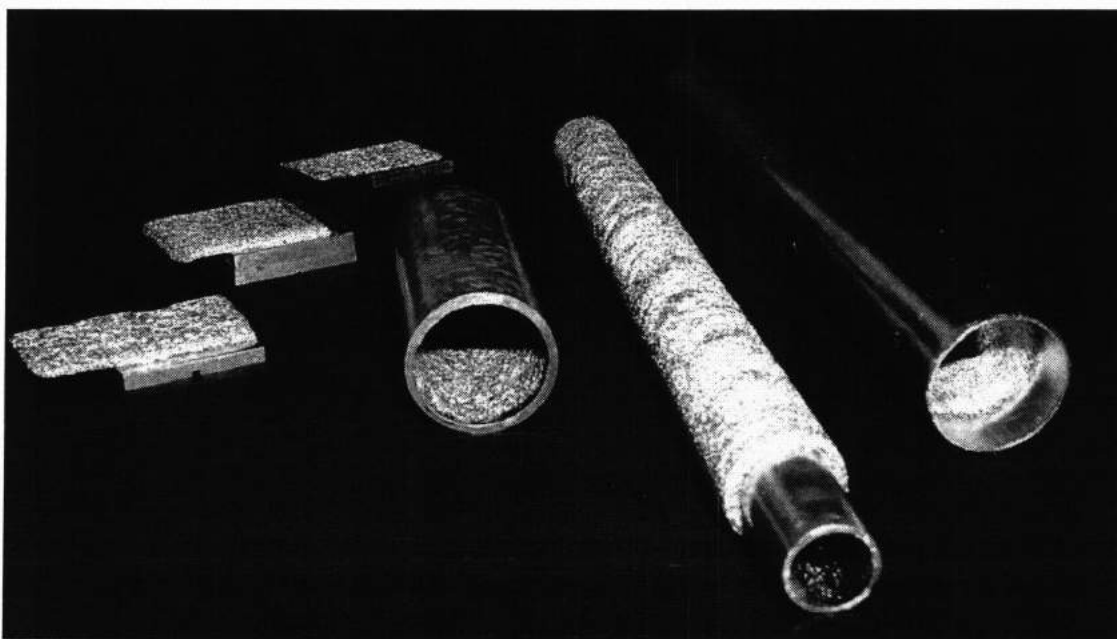
Rysunek 1. Elementy wymienników ciepła i „rur cieplnych” z pokryciami strukturalnymi typu SKP (CPS) wykonanymi przez autora.
