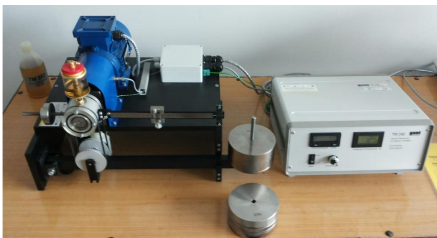
Stanowisko do badań tribologicznych w łożyskach ślizgowych
