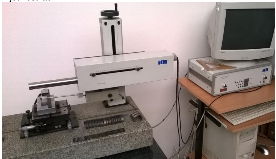
Stanowisko do analizy struktury geometrycznej powierzchni Kształtograf PG2/200
