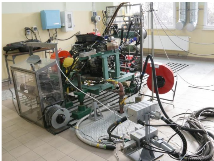
Stanowisko hamowniane z silnikiem o zapłonie samoczynnym Fiat 1.3 MultiJet
