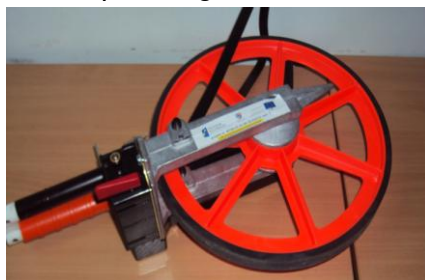
Przyrząd pomiarowy do sporządzania szkiców wypadkowych MLCM™
