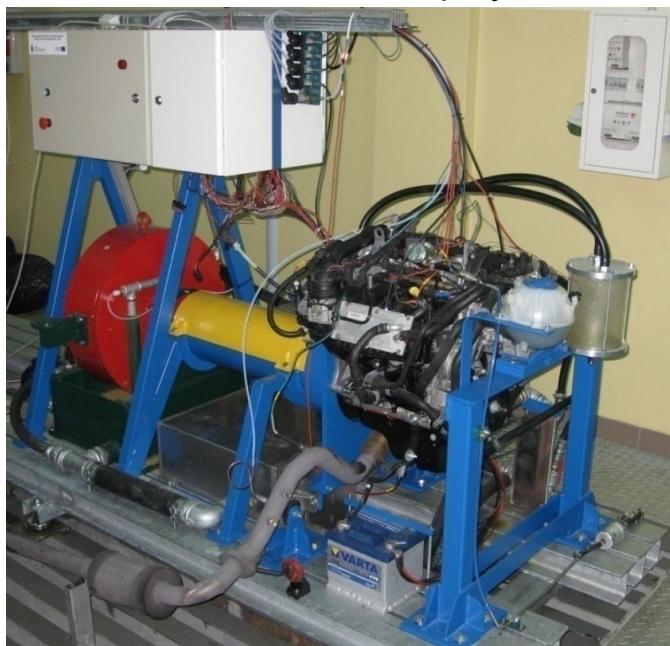
Stanowisko hamowniane z silnikiem o zapłonie wymuszonym VW 1.2 FSI
