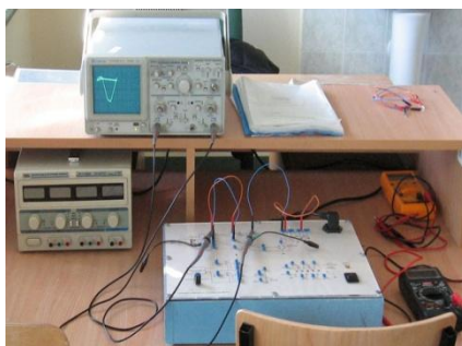
Stanowisko do badania prostowników niesterowanych i sterowanych. Dodatkowo makieta zawiera układ powielacza napięcia.
