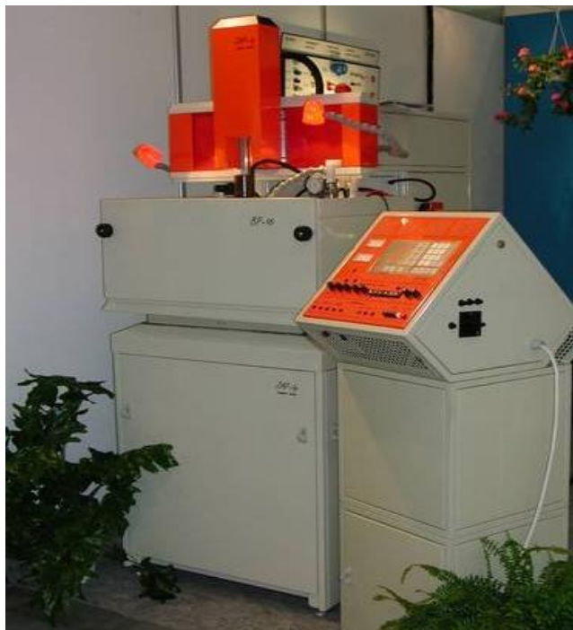
Drażarka elektroerozyjna EDM BP-95
