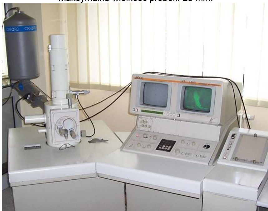
Mikroskop skaningowy JEOL JSM-5400
