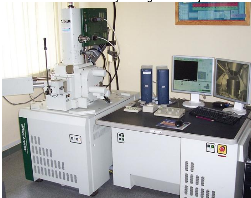
Mikroskop skaningowy JEOL JSM-7100F
