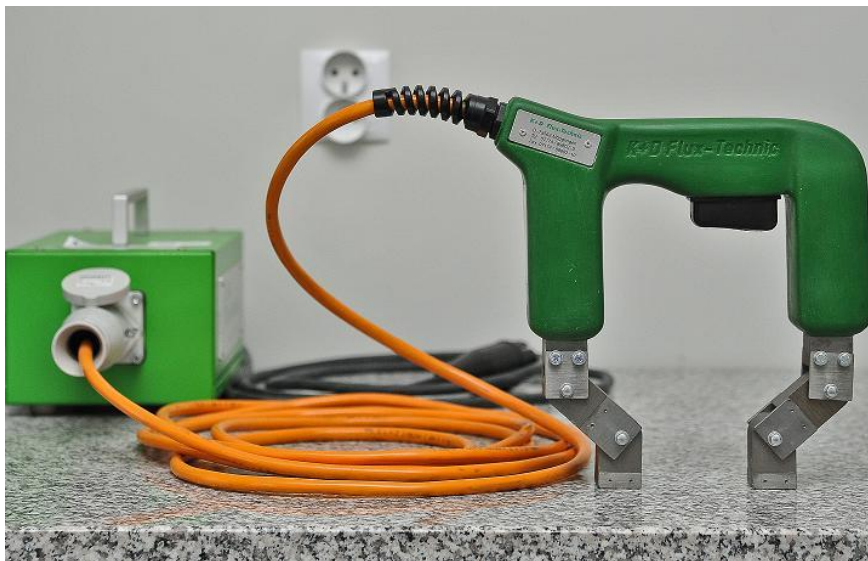
Defektoskop jarzmowy K+D FLUX TECHNIK AC 230
