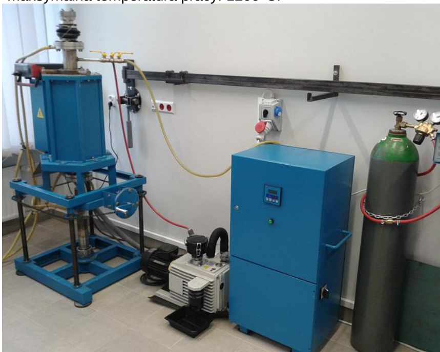
Piec próżniowy rurowy z tłoczyskiem firmy Czylok
