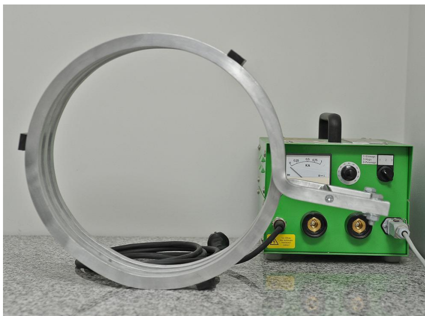
Defektoskop prądowy 1KA K+D FLUX TECHNIK PORTAFLUX 1000
