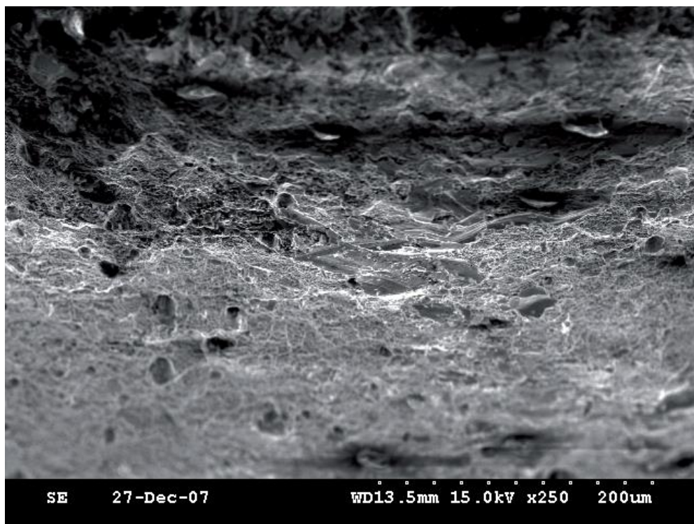
c) Mikrostruktura obszaru zahartowanego ze stanu stałego granicząca z strefą przejściową
